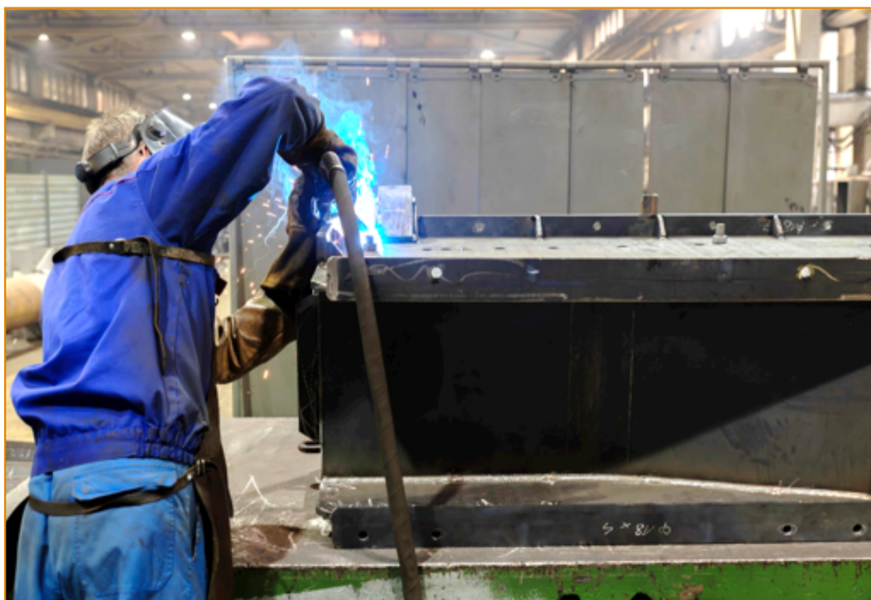
Rys. 2 Jeden z etapów produkcji elementu nośnego konstrukcji stalowej.
